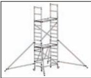
19. Setzen Sie sich in die Luke der Plattform und befestigen Sie die Geländerstreben von innen nach außen an den Vertikalrohren des Geländerrahmens. Befestigen Sie anschließend die Bordbretter. Siehe unter II.IX.
