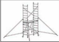
18. Stellen Sie sich nun auf die Hilfsplattform und befestigen Sie zuerst die Geländerrahmen und dann eine Plattform mit Luke auf der 7. Sprosse des Aufbaurahmens.
