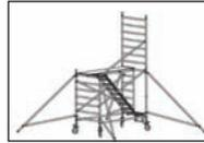
12. Stellen Sie sich auf die 5. Stufe der Treppe und befestigen Sie einen Aufbaurahmen auf der anderen Seite des Gerüsts. Sichern Sie den Aufbaurahmen mit den Sicherungsstiften.
