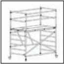
7. Montieren Sie danach die Bordbretter von innen nach außen an den Vertikalrohren des Geländerrahmens (siehe unter II.IX).
