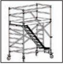
9. Befestigen Sie am Treppenauslauf ein Geländer an der gegenüberliegenden Geländerstrebe und am Geländerrahmen.
