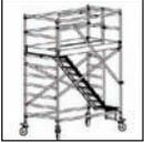
Das Treppengerüst mit einer Plattformhöhe von 2,2 Metern ist nun einsatzbereit.
