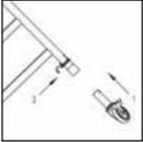
1b. Für höhere Konfigurationen befestigen Sie die Lenkrollen mit  $\varnothing$  200 mm mit Spindel auf dem Klappgerüststrahlen.
