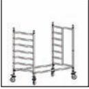
2. Befestigen Sie 1 Diagonalstrebe an der Durchgangseite zwischen der 3. Sprosse des Aufbaurahmens und der 7. Sprosse des Basis-Durchlaufrahmens. Befestigen Sie dann 2 Diagonalstreben gekreuzt auf der anderen Seite zwischen der 2. und 6. Sprosse des Basis-Aufbaurahmens und dem Basis-Durchlaufrahmen. Richten Sie mit der Spindelmutter auf der Radspindel den Basisrahmen sowohl über die Quer- als auch über die Längsseite mit einer Wasserwaage horizontal aus.
