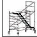
5. Stellen Sie sich dann auf die 5. Stufe der Gerüsttreppe. Befestigen Sie einen Geländerrahmen auf dem Basis-Aufbaurahmen des Fahrergerüsts. Sichern Sie den Geländerrahmen mit den Sicherungsstiften.
