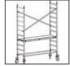
Richten Sie die Lenkrollen so aus, dass sie nach außen zeigen. Blockieren Sie die Lenkrollen, indem Sie den Bremshebel niederdrücken. Richten Sie anschließend den Basisrahmen sowohl über die Längs- als auch über die Querseite mit einer Wasserwaage, die Sie auf die niedrigste Sprosse und auf die Horizontalstrebe legen, horizontal aus.
