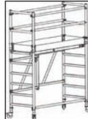
Das Gerüst mit einer Plattformhöhe von 1,8 Metern ist nun einsatzbereit.
