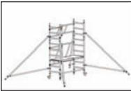
11. Befestigen Sie zwei Geländerrahmen auf dem Klappgerüstrahmen mit 3 Sprossen und sichern Sie die Geländerrahmen mit den Sicherungsstiften.
