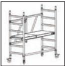
5. Stellen Sie sich auf die Plattform und befestigen Sie nun 2 Geländerrahmen auf dem Klapprahmen und sichern Sie die Geländerrahmen mit Sicherungsstiften.
