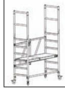
6. Montieren Sie 4 Geländerstreben von innen nach außen auf den Vertikalrohren des Geländerrahmens.
