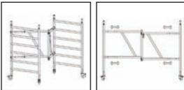
2b. Für höhere Konfigurationen befestigen Sie auf der offenen Seite des Klappgerüststrahmens 1 Horizontalstrebe von innen nach außen unter der 1. Sprosse auf den Vertikalrohren.
