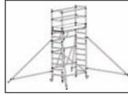
Das Gerüst mit einer Plattformhöhe bis 2,7 Metern ist nun einsatzbereit.
