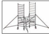
Falls erforderlich (siehe Ballastierungstabelle unter IX), befestigen Sie mit Hilfe der Ballasthalter die Ballastgewichte auf den 4 Vertikalrohren des Aufbaurahmens.
