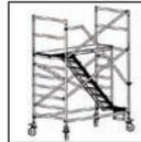
7. Befestigen Sie auf der Plattformseite, sitzend von der Plattform aus, die Geländerstreben von innen nach außen auf den Vertikalrohren der Geländerrahmen. Bringen Sie auf der Treppenseite 1 Handlauf unter der obersten Sprosse auf den Vertikalrohren der Geländerrahmen an.
